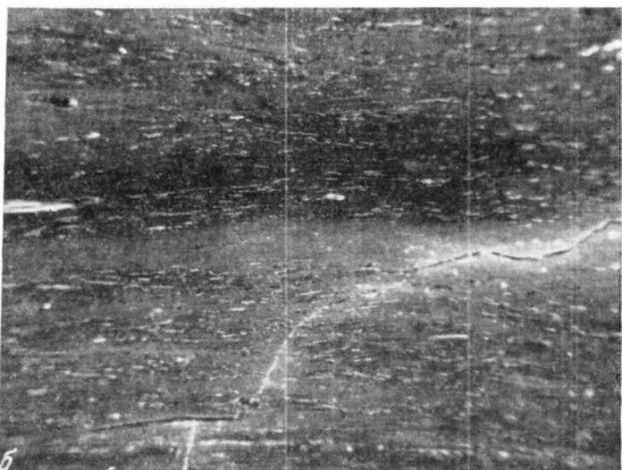
Фиг. 3б. Уголь маловосстановленного типа *a* и *аб*.  $\times 56$
